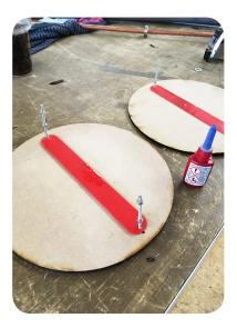
14. Poser de la colle sur les 3 pièces 3D de la tiges assemblée à l'étape 10 et fixer les panneaux cylindriques. Faire correspondre les tiges aux trous, serrer les écrous. Laisser sècher. Réitérer pour le verso. (voir photo)
